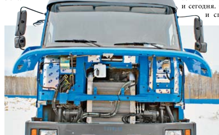
За облицовкой нет ничего лишнего. Все монтируется изнутри кабины – не очень удобно, зато изолировано от влаги и морозов
