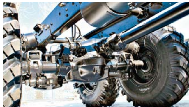
В редукторах ведущих мостов задней тележки нет межосевого дифференциала – ломаться здесь нечему
