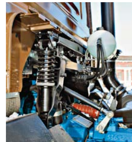
Даже пружинная подвеска кабины очень эффективна. У «375» – хуже...
