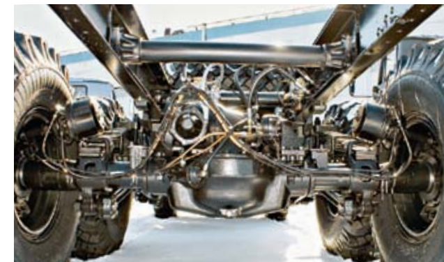
В передней и задней подвеске каких-то масштабных изменений нет – разве что реактивные штанги с сайлентблоками
