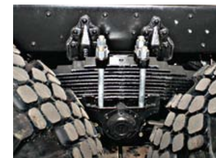
У балансира стремянки расположены просто образцово – вверх гайками
