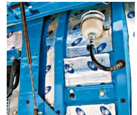
Под тормозную жидкость теперь остался только один бачок – для сцепления
