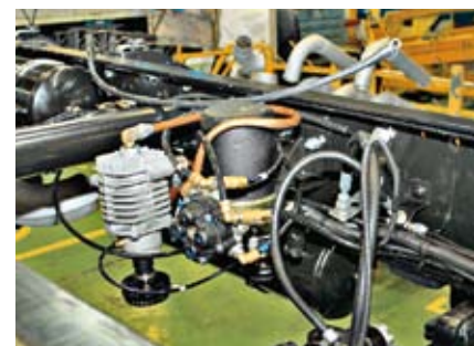
Пневмоаппаратура тормозов импортная – производства Wabco
