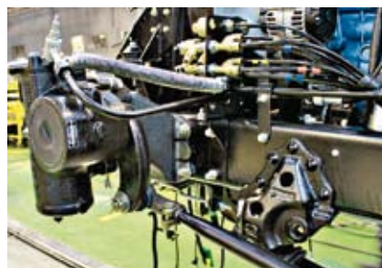
Гидроусилитель RBL рассчитан на большее давление. Руль стал легче
