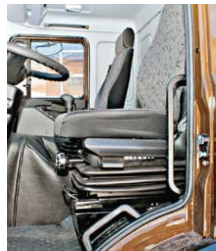
Сиденья лицензионные Grammer, с пружинной подвеской, тканевой обивкой
