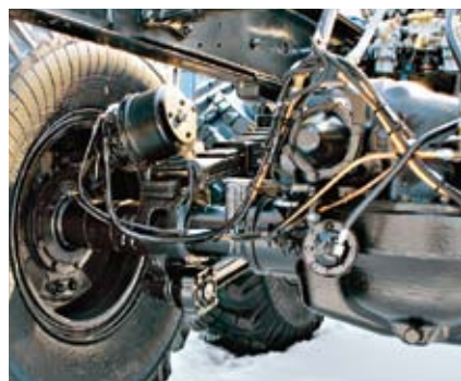
Блокировка межколесных дифференциалов здорово повышает проходимость
