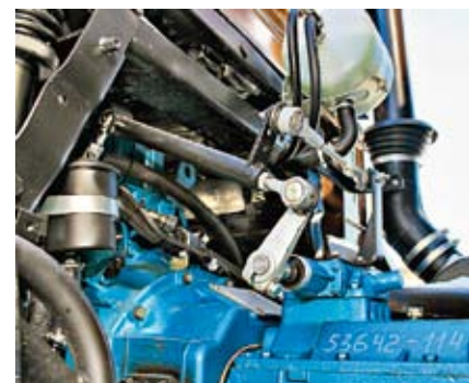
Управление коробкой на бескапотнике – телескопической тягой
