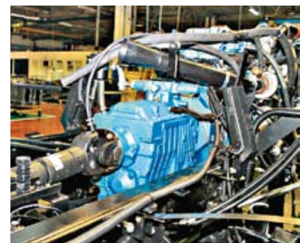
Ярославские 5-ступенчатые коробки ставят на любые «Урал М»
