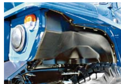
В крыльях теперь устанавливают пластмассовые брызговики
