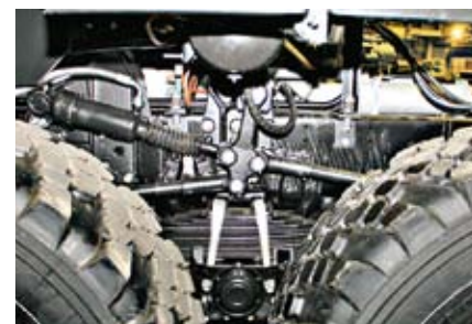
Немного другая конструкция балансира на управляемых мостах 8x8
