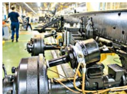
Энергоаккумуляторы установлены в тормозные суппорты консольно
