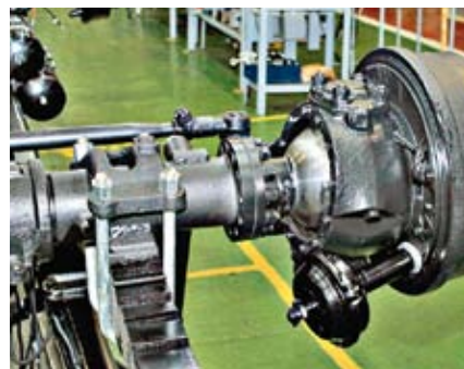
У передних мостов для надежности изменили поворотный кулак и ШРУСы
