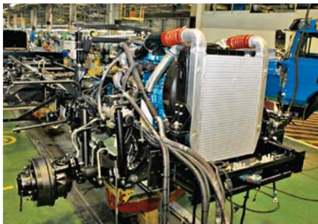
Радиатор и теплообменник интеркулера – все смонтировано сверху рамы. Повредить их в колее невозможно
