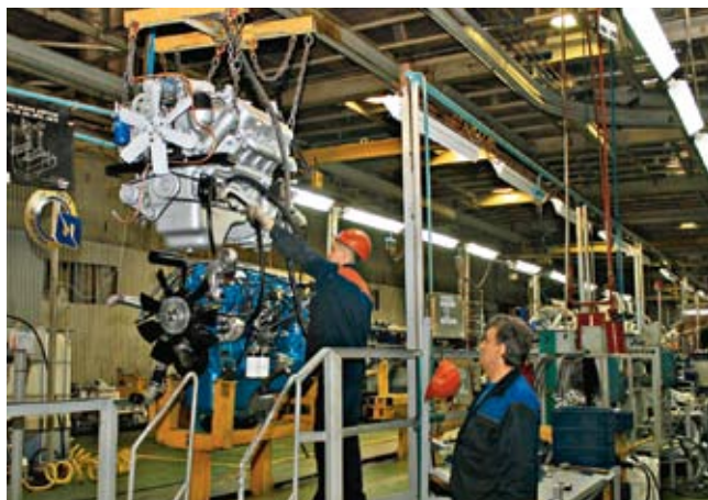
Рядные ярославские «шестерки» постепенно вытесняют с конвейера «АЗ Урал» дизели ЯМЗ V6 и V8
