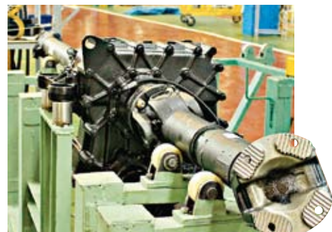
Раздатку тоже модернизировали. Карданы – с торцевыми шлицами
