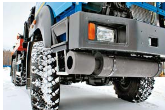
Бампер стальной – прочный и простой. Светотехника недорогая. Впереди – две буксирные проушины
