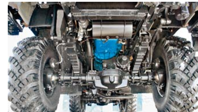
Передний мост выдерживает нагрузку 6,5 тонны, а задний балансир – 16 тонн, то есть по 8 тонн на ось
