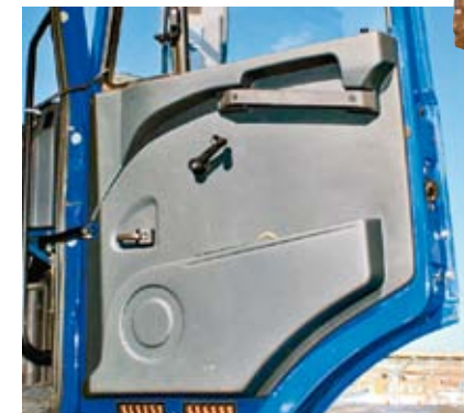
Обивка дверей абсолютно новая, цельноформованная, пластмассовая
