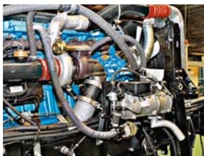
По правому боку установлен турбокомпрессор и жидкостный подогреватель
