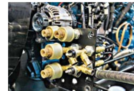
Для контроля за давлением в пневмоконтурх есть несколько датчиков
