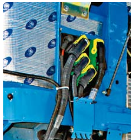
На автомобилях применены новые пучки проводов, с новыми разъемами
