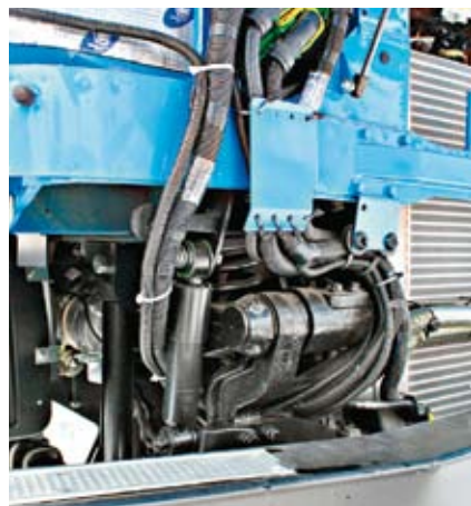
Подвеска кабины – четырехточечная, пружины и амортизаторы разнесены
