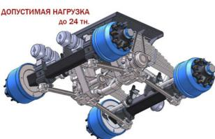
Полуприцепы производства «УралСпецТранс» могут оснащаться **рессорно- балансирной подвеской с реактивными штангами**. Такой тип подвески выполняется на продольных полуэллиптических листовых рессорах с продольными реактивными штангами.
