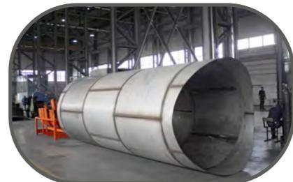
Сварочные работы осуществляются роботизированными установками и полуавтоматами в высокоточных кондукторах.
